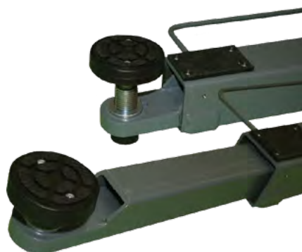
Телескопические лапы максимальная длина 1365мм
