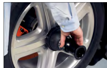
Стенд комплектуется пневмозажимом AutoClamp
