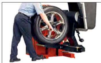
Стенд оснащен подъемником колеса
